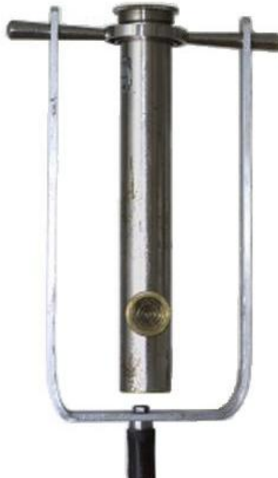
Kuva 2. Cajanuksen putki telineessään. Putken sisällä oleva peili heijastaa ylhäältä tulevan kuvan, jota katsotaan kyljessä olevasta tähtäysreiästä (kuva: Pekka Voipio).
