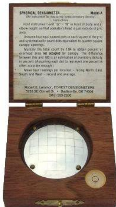
Kuva 4. Densiometri. Latvussulkeumaa ja -peittoa voidaan arvioida laitteessa olevan kuperan peilin heijastamasta kuvasta peiliin uurretun ristikon avulla.
